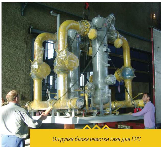
Отгрузка блока очистки газа для ГРС
