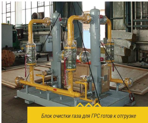
Блок очистки газа для ГРС готов к отгрузке
